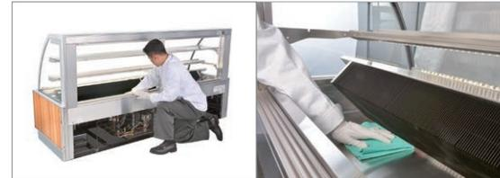
背面より冷却コイル下が清掃可能。冷却コイルには専用ハンドルが備わっておりますので、誰でも簡単に冷却コイルを軽く持ち上げる事ができます。
